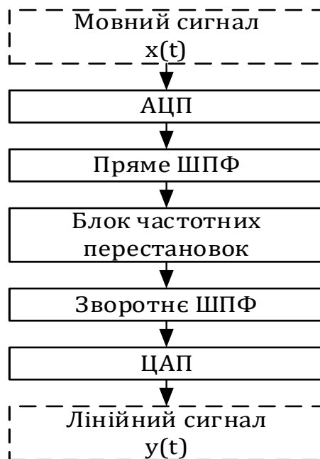
Рисунок 2.5 - Схема частотних перестановок телефонного сигналу на основі ШПФ
