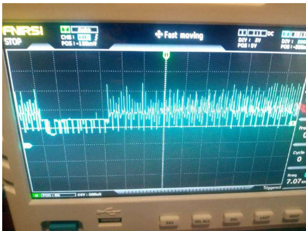
Рисунок 3.14 – Осцилограма скрембльованого сигналу
