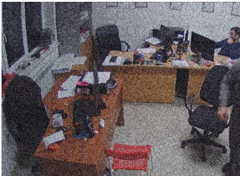
Рисунок 3.17 - Дескрембоване відеозображення, отримане з демонстраційної системи скремблера хаотичного аналогового відео за допомогою бездротового FM-радіоканалу.
