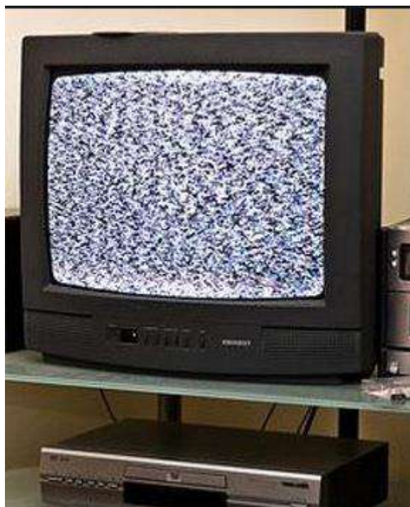
Рисунок 1.1 - Шум в аналоговому телевізійному приймачеві
