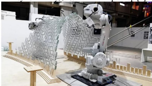
Рисунок 2 – Промислові роботи будують скляну арку [2]
