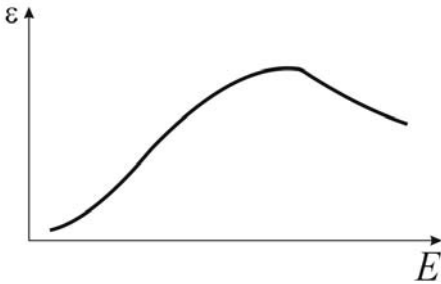
Рисунок 2.2 – Залежність діелектричної проникності сегнетоелектрика від напруженості електричного поля
