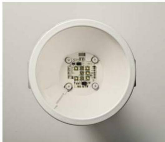
Рисунок 1.16 - У деяких застосуваннях вигідніше замість світлодіодної матриці використовувати цілий світлодіодний модуль, що включає в себе блок живлення і оптичні компоненти
