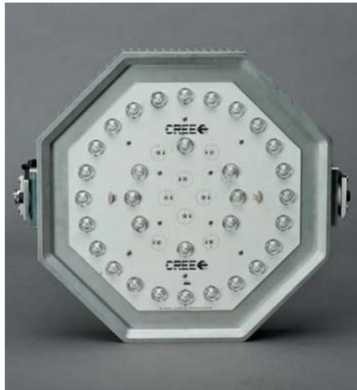
Рисунок 1.14 - У системах освітлення з окремими світлодіодами їх монтаж на друковану плату проводиться за допомогою пайки в конвекційної печі оплавлення. Цей процес більш складний і дорогий
