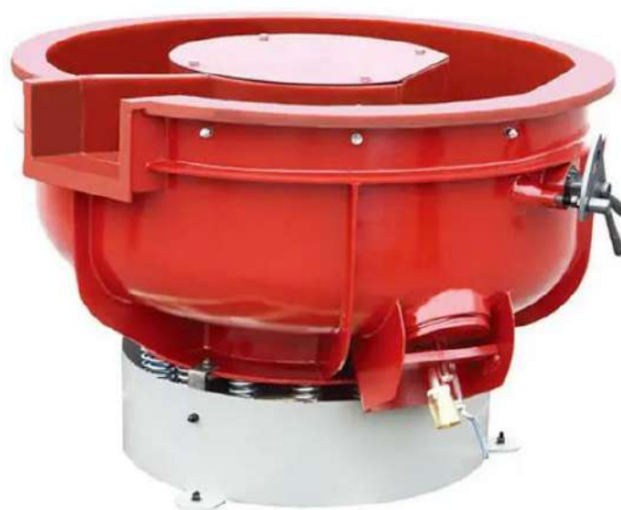
Рисунок 2.13 – Вібраційна установка для видалення задирок: модель VBS(B) [27]
