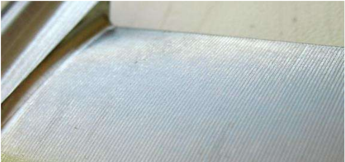
Рисунок 4.3 – зовнішній вигляд пера лопатки після фрезерування з подачею S = 0,2 мм/об (партія №6) перед фінішною обробкою
