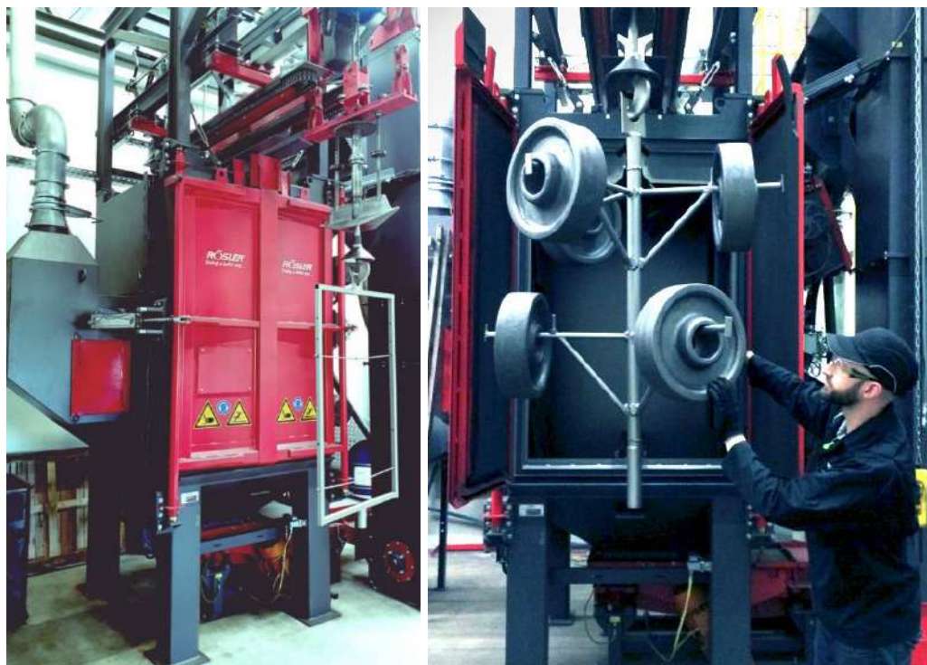
Рисунок 2.4 – Зовнішній вигляд установки для дробоструминної обробки та завантаженням в неї залізних коліс [13]
