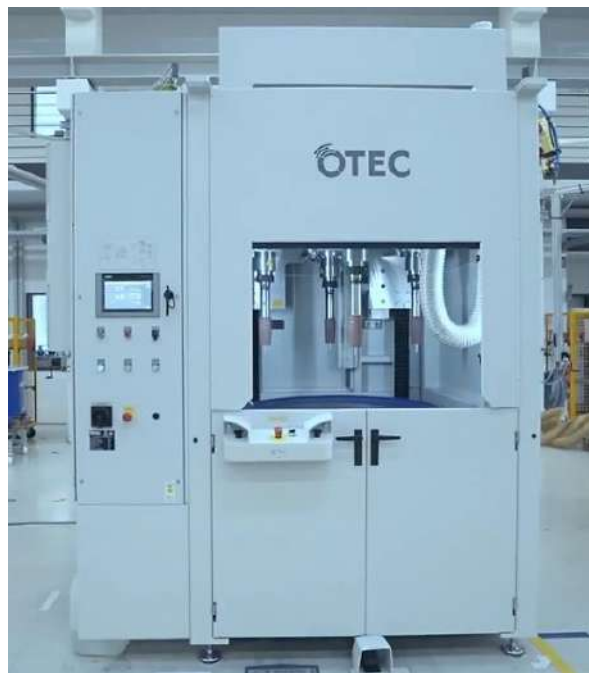
Рисунок 2.11 – Машина для масової обробки Otec Präzisionsfinish GmbH [25]
