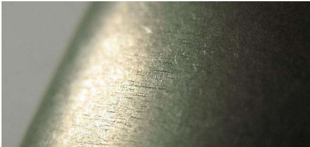
Рисунок 4.6 – Зовнішній вигляд пера лопатки (партія №6) після абразивної обробки F80 та ВАП 5 годин
