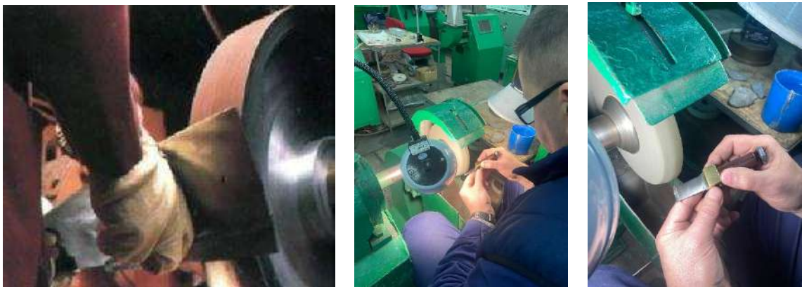
Рисунок 1.3 –Процес ручного полірування лопаток [7]
