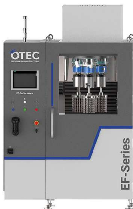
Рисунок 2.1 – Установка для електрофінішної обробки OTEC EF-Series [12]
