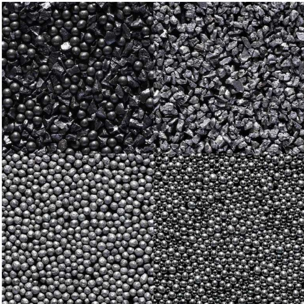
Рисунок 2.6 – Сталевий «дріб», котрий застосовують при дробоструминній обробці [13]
