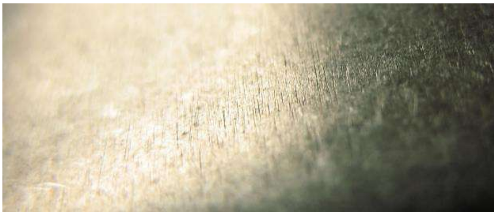
Рисунок 4.5 – Зовнішній вигляд пера лопатки (партія №5) після абразивної обробки F120 та ВАП 4 години
