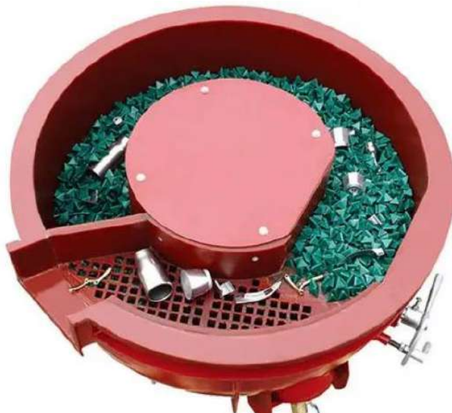
Рисунок 2.14 – Віброабразивна обробка деталей в вібраційній установці VBS(B), з керамічним наповнювачем [27]
