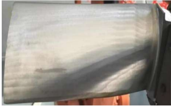
Рисунок 1.2 – Зображення лопатки ГТД після обробки СШ [9]
