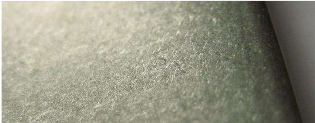
Рисунок 4.4 – Зовнішній вигляд пера лопатки (партія №4) після ВАП 5 годин
