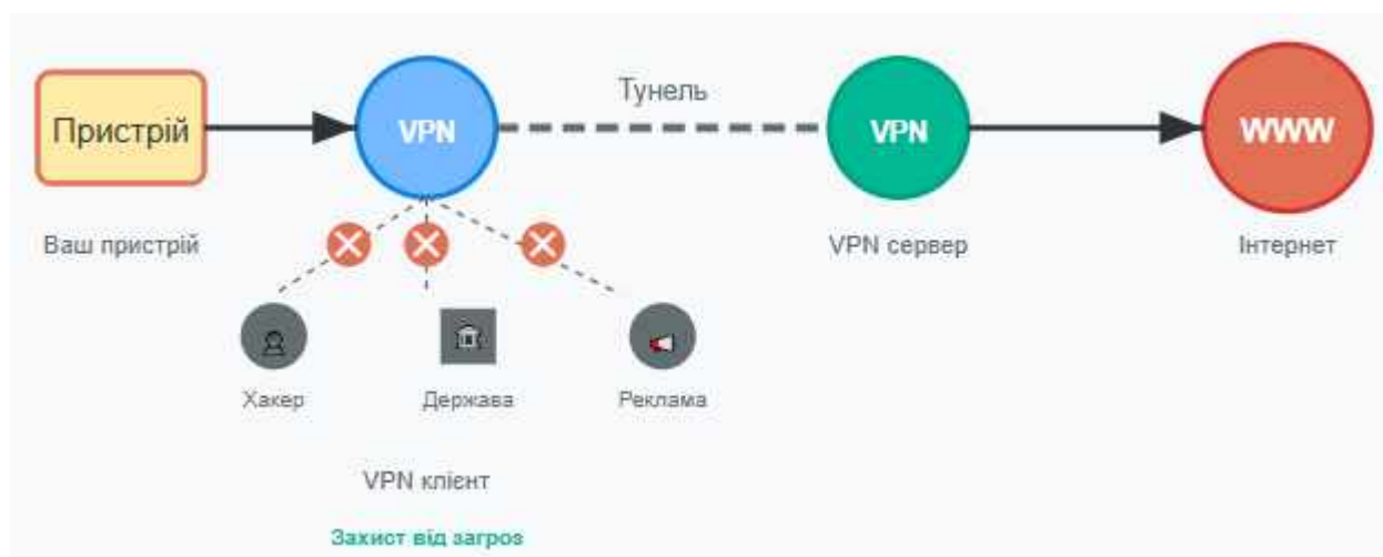
Рисунок 1.3 - принцип роботи TLS VPN протоколу
