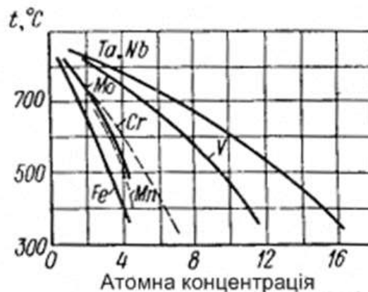
Рисунок 1.6 – Залежність температури мартенситного перетворення титанових сплавів від вмісту \beta - стабілізаторів
