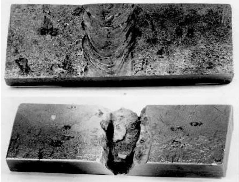
Рисунок 5.2 – Зовнішній вигляд зразків зварного з'єднання зі сталі 12X18H10T
