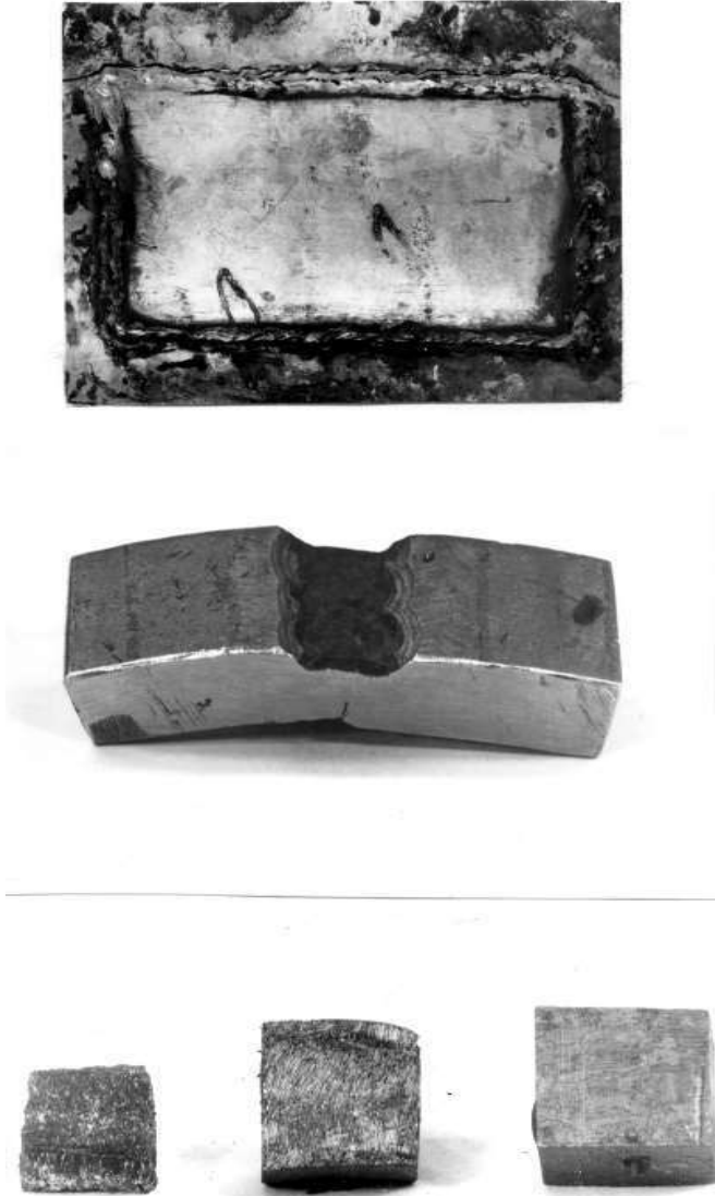
Рисунок 5.8 – Зовнішній вигляд і мікроструктури зразків після експлуатації та лабораторних випробувань
