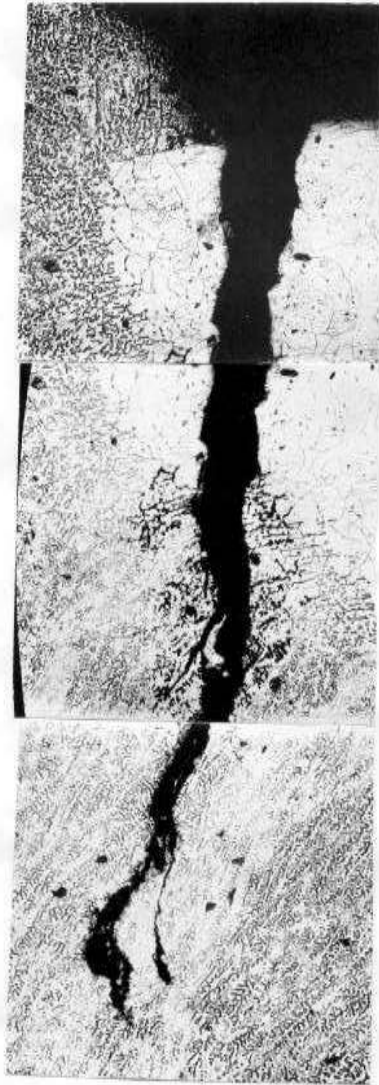
Рисунок 5.5 – Тріщина корозійного розтріскування трубопроводу із сталі 12X18H10T ( \times 100 )
