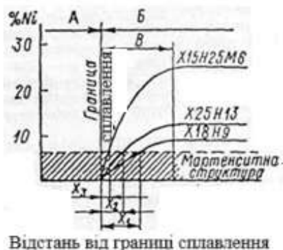
А, Б – зварювані елементи; В – ширина зони сплавлення; X1, X2, X3 – ширина мартенситного прошарку
