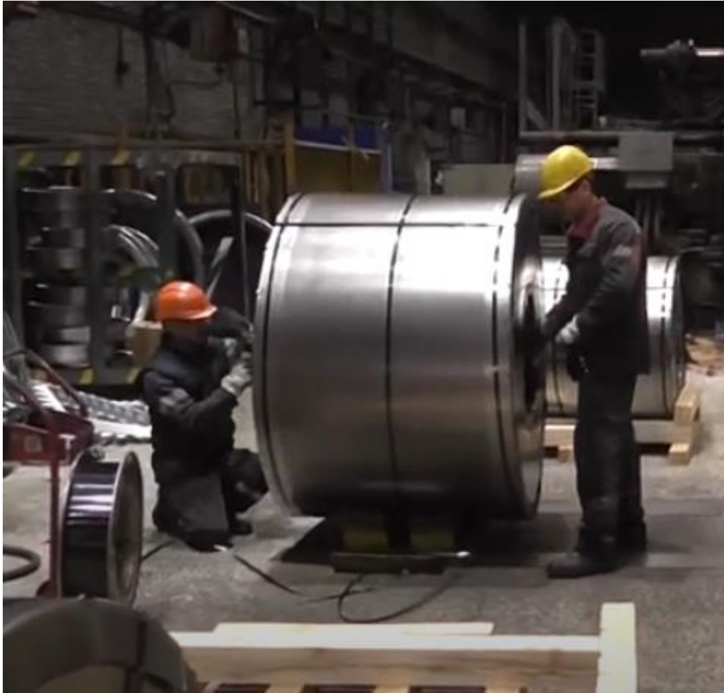
Рисунок 1.3 – Процес пакування рулонів металопрокату
