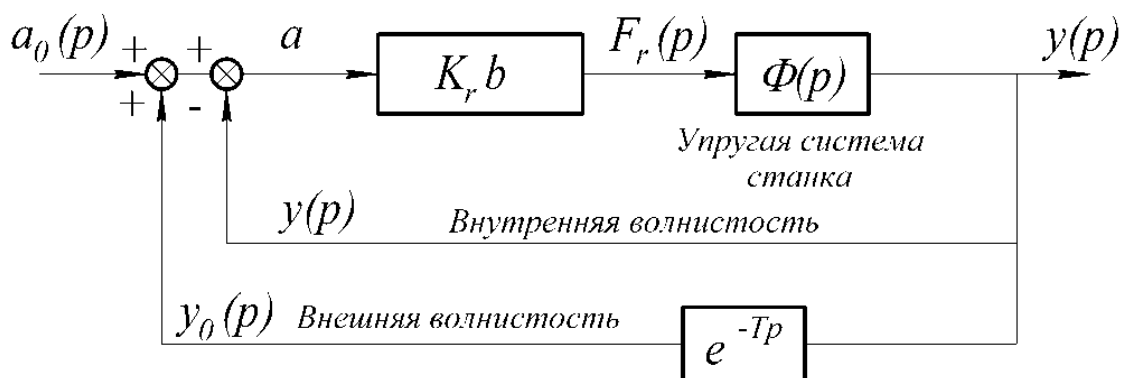
Рисунок 1.2 - Структурна блок-схема динамічної системи при поперечному точінні диска [33]
