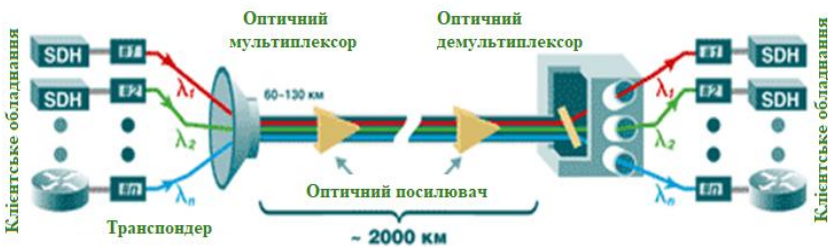
Рисунок 1.12 – Принцип передачі та прийому DWDM-систем
