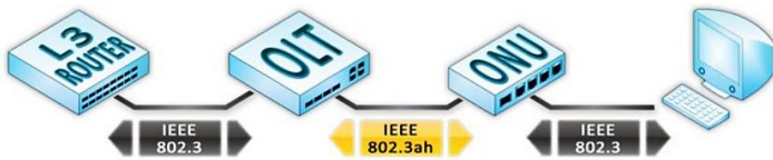
Рисунок 2.6 - Алгоритм роботи мережі PON
