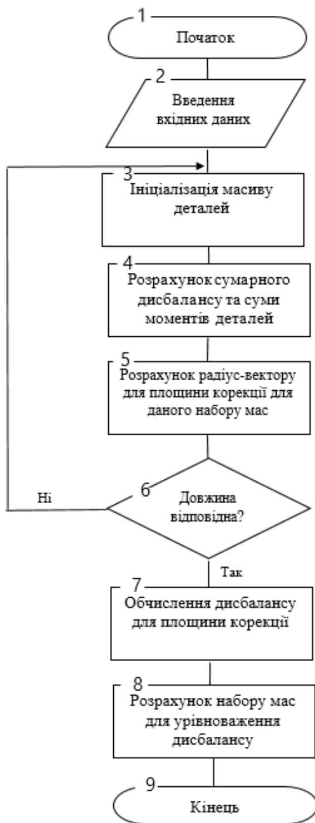
Рисунок 3.3 – Схема алгоритму роботи модуля розрахунку параметрів врівноваження ротора
