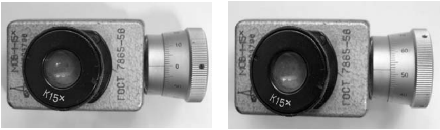
Рисунок 2.6 – Послідовне вимірювання діагоналі відбитку за допомогою окуляр-мікрометра
