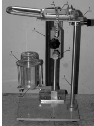
Рисунок 3.1 – Пристрій для визначення фізичної густини методом гідростатичного зважування
