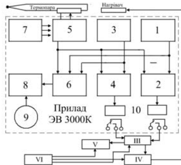
Рисунок 6.5 – Структурна схема блоку керування електропіччю
