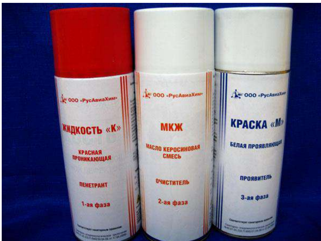
Рисунок 3.1 - Набір для кольорової дефектоскопії ЦМ-15В
