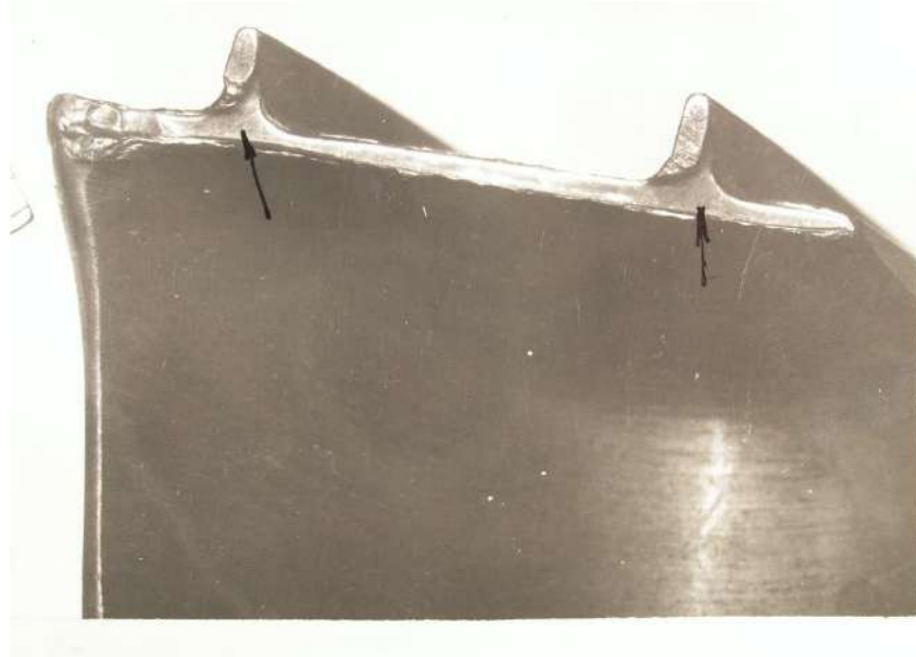
Рисунок 1.3 – Спрацьовування робочої лопатки турбіни після напрацювання 2458 годин.
