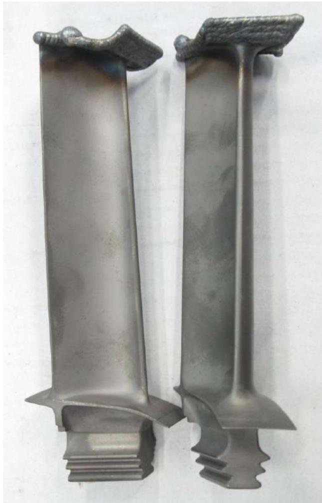
Рисунок 1.9 - Лопатки ТСТ, відновлені методом ППН
