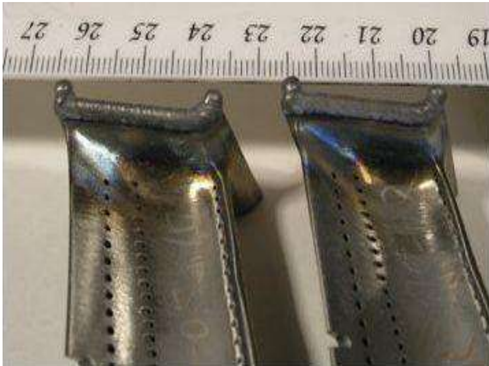
Рисунок 1.10 - Наплавлені лопатки методом ППН
