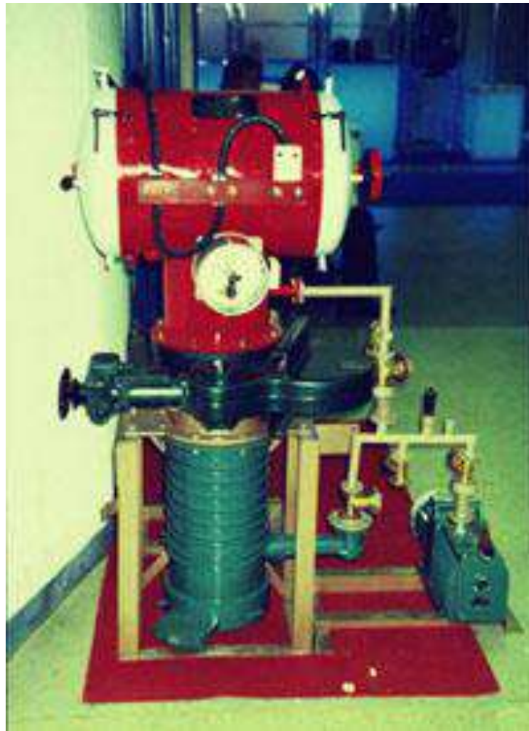
Рисунок 4.3 – Вакуумна піч з екранною теплоізоляцією
