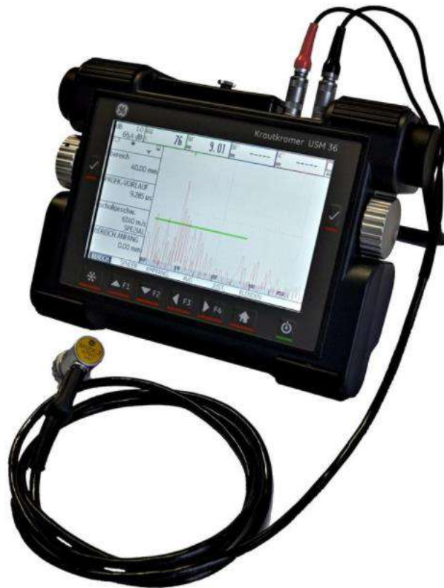
Рисунок 3.2 – Зовнішній вигляд ультразвукового дефектоскопу USM 36
