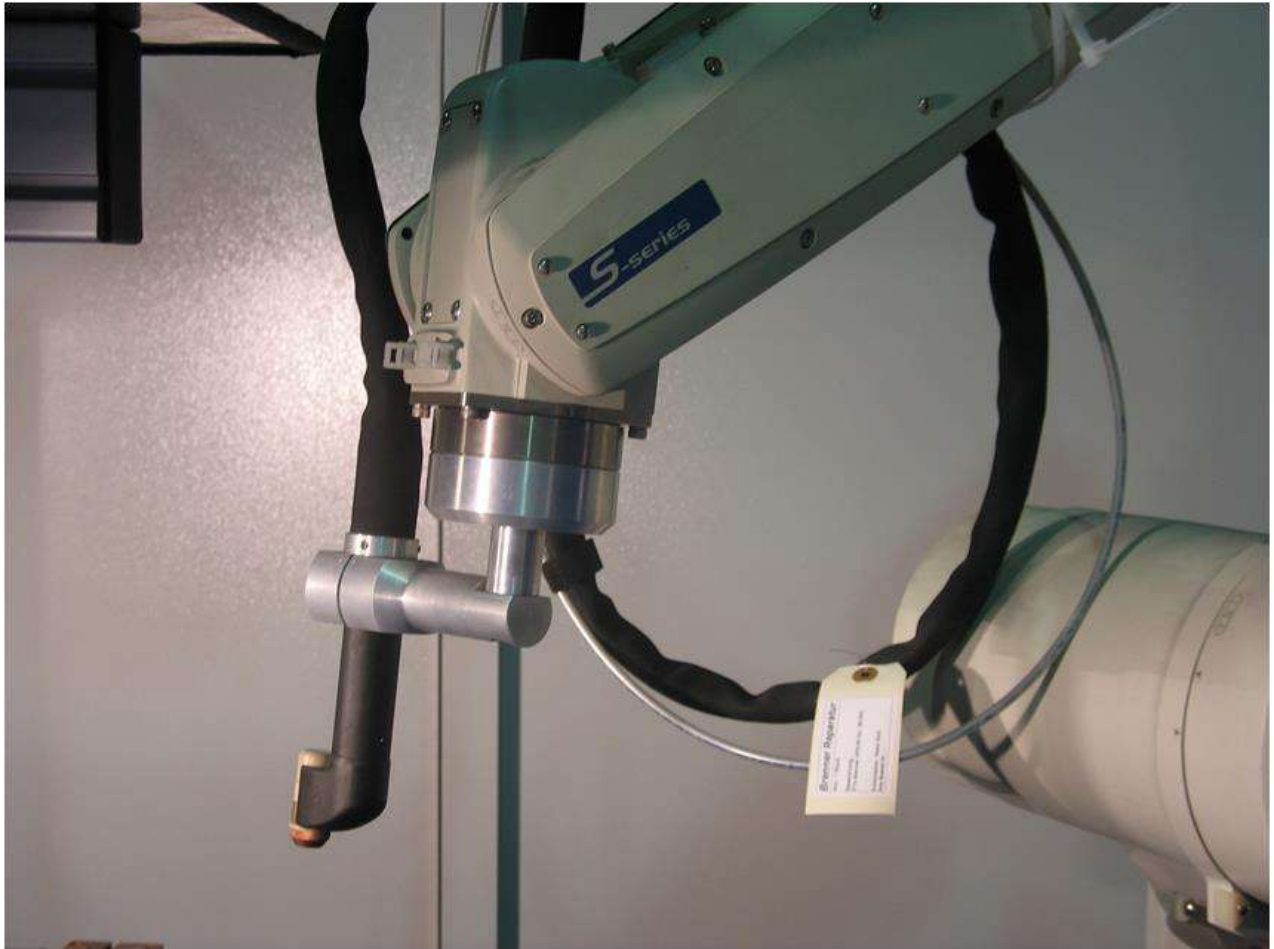
Рисунок 4.2 – Зовнішній вигляд плазмоторона для ППН
