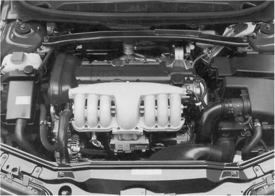
Рисунок 7.4 - Двигун автомобіля Volvo (зверніть увагу на особливості конструкції впускного колектора)
