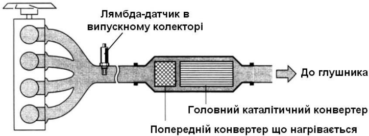
Рисунок 7.14 - Попередній конвертер з електричним підігрівом
