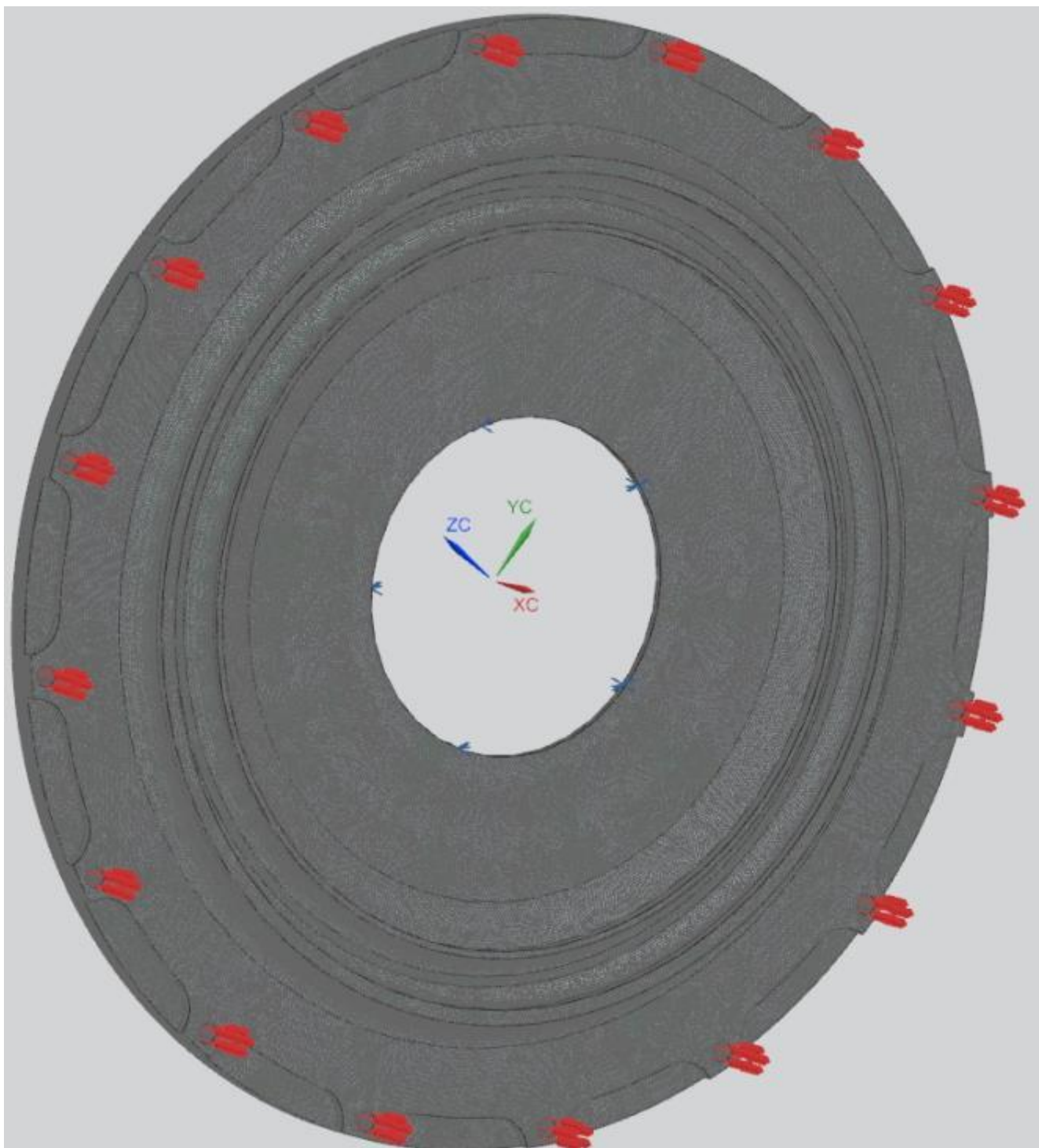
Рисунок 4.3 – Схема прикладення обмежень та навантажень
