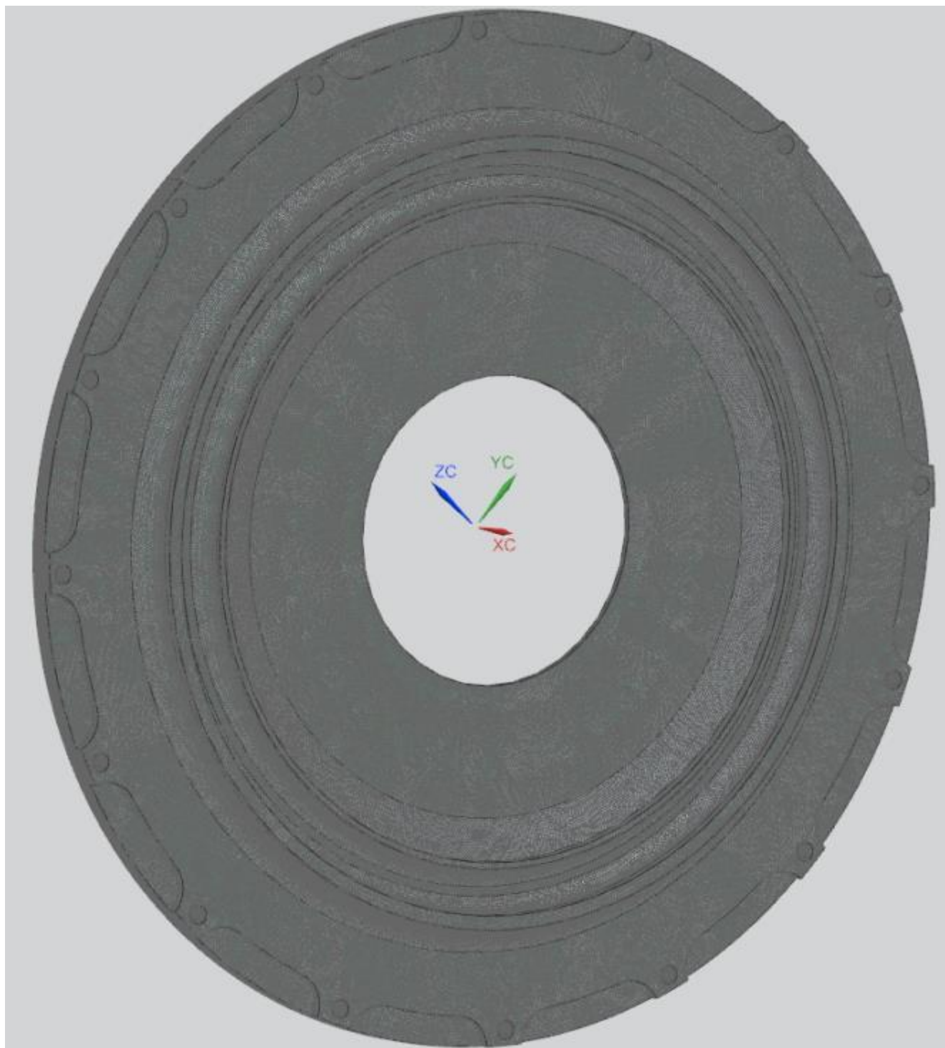
Рисунок 4.2 – Модель діафрагми розбита на сітку кінцевих елементів
