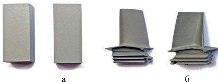
а - прямокутні зразки; б - натурні деталі
