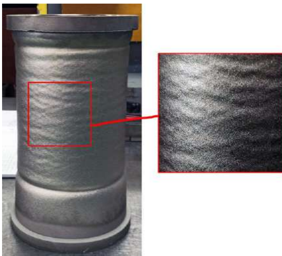
Рисунок 3.5 – Зовнішній вигляд катода ГМ після експлуатації
