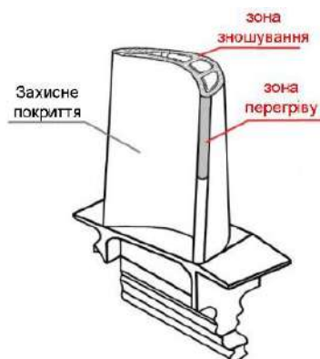
Рисунок 1.4 – Схема робочої лопатки ТВД авіаційного ГТД із зоною перегріву [52]
