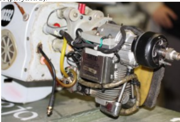
Рисунок 2 - 4-х тактний двигун Saito FG-40 [3]
