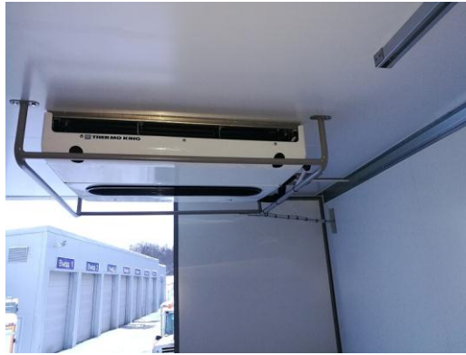
Рисунок 2.7 – Стельова система вентиляції кузова
