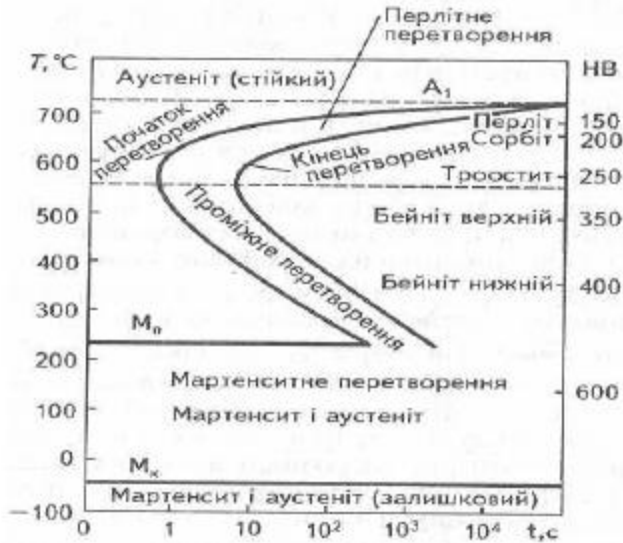
Рисунок 7.3 – Діаграма ізотермічного перетворення аустеніту евктоїдної сталі (0,8% C)
