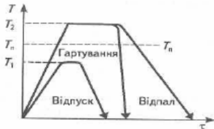
Рисунок 7.1 – Схематичне зображення різних видів термічної обробки
