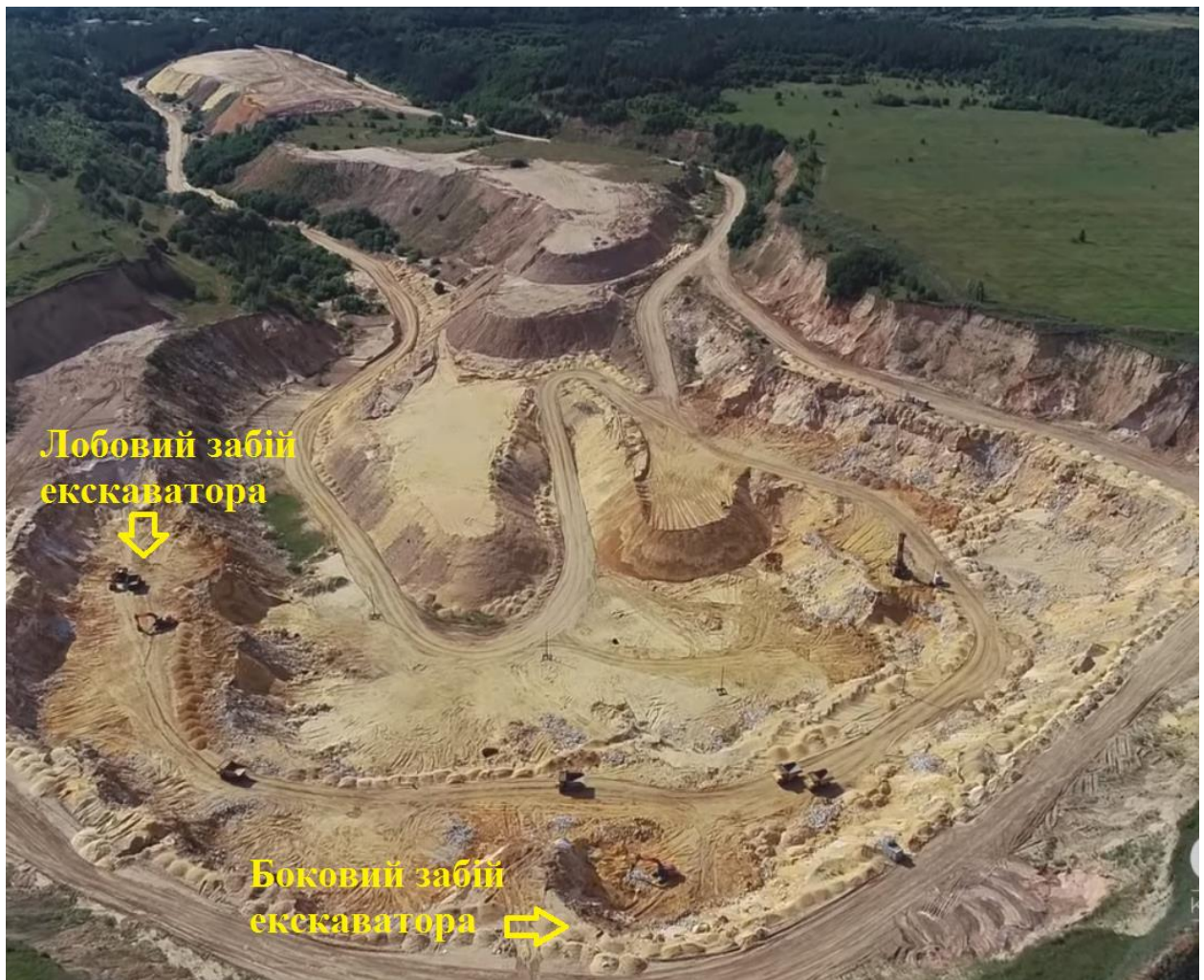
Рисунок 2.2 – Варіанти роботи екскаваторів на Глухівському кар'єрі кварцитів
