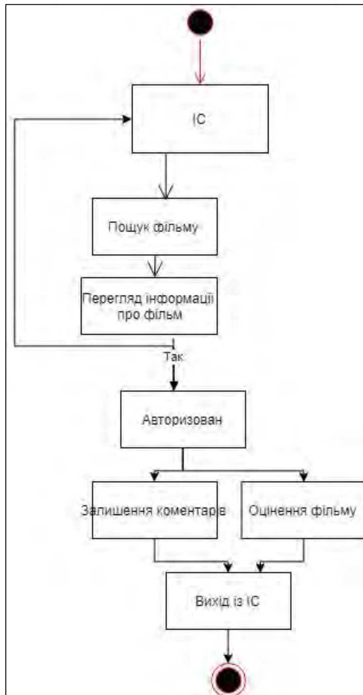
Рисунок 3.3 – Діаграма станів програмного забезпечення для подання інформації про кінострічки
