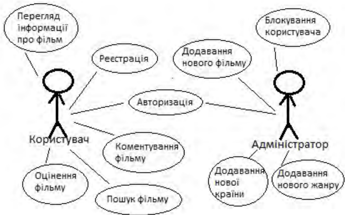
Рисунок 3.2 – Схема функціонування у вигляді діаграми прецедентів програмного забезпечення для подання інформації про кінострічки
