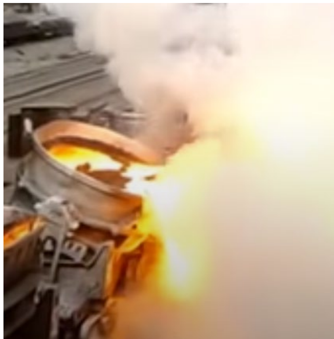
Рисунок 1.3 – Зливання гарячого шлаку у басейн грануляції
