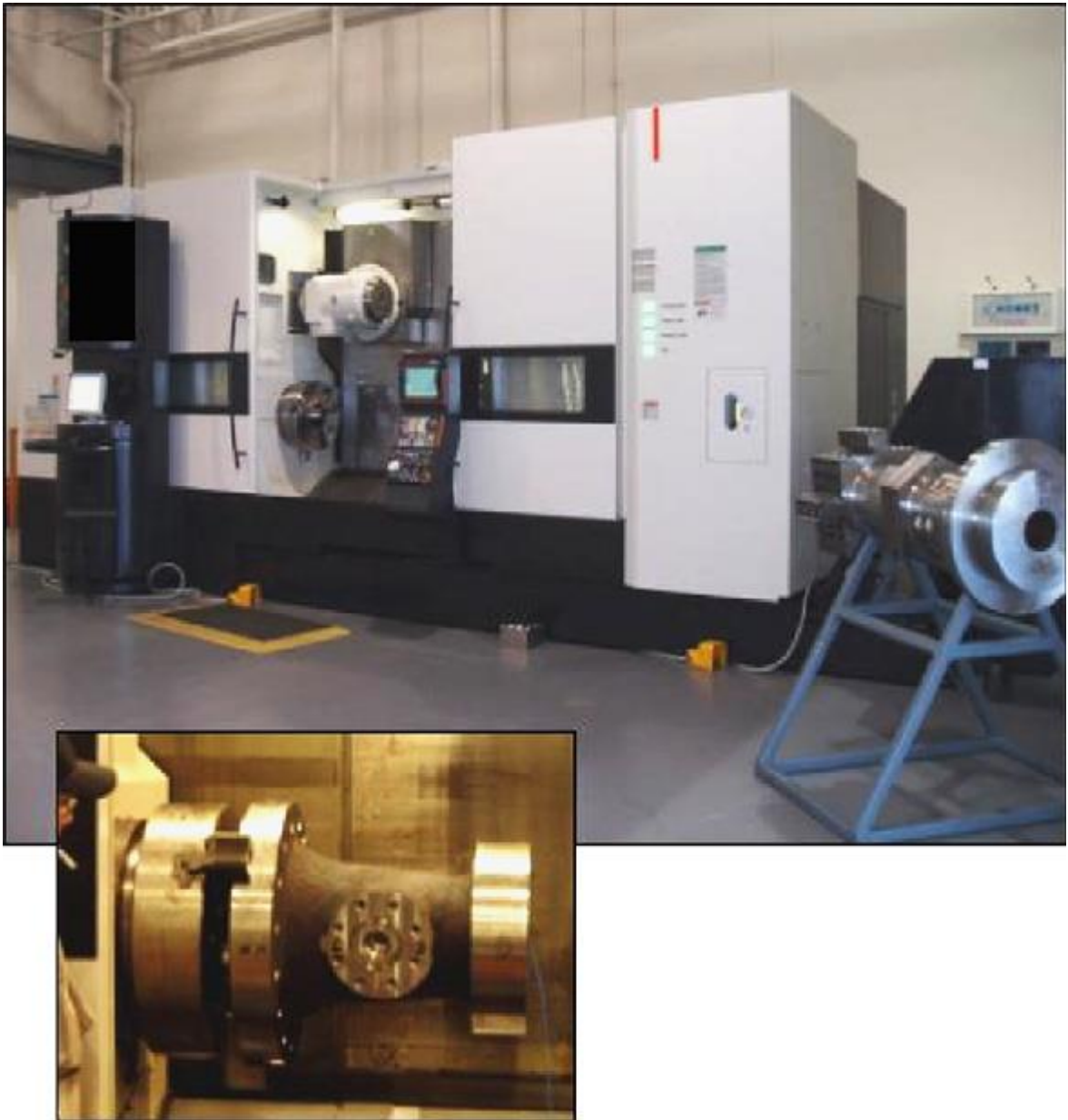
Рисунок 5.12 – Високопродуктивний багатоцільовий 5-ти координатний токарно-фрезерний верстат [30]
