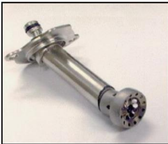
Рисунок 5.11 – Спеціальний 9-ти координатний токарно-фрезерний верстат і виготовлена на ньому форсунка ГТД [30]
