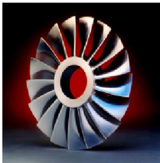
Рисунок 5.16 – Приклад виконання 5-ти координатного ОЦ і обробленої на ньому деталі [26]
