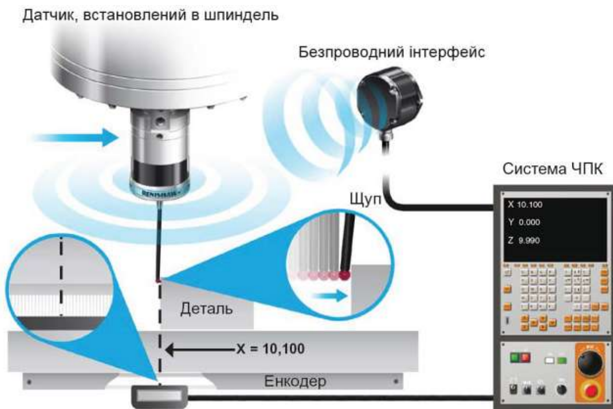
Рисунок 3.1 – Безконтактна лазерна вимірювальна система [14]
