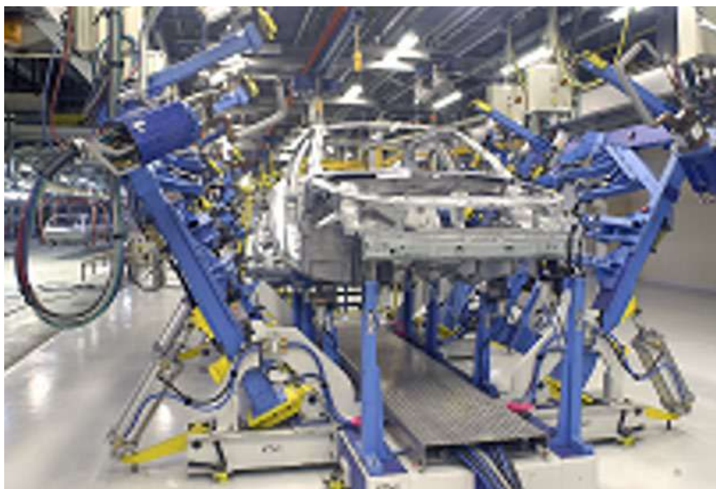
Рисунок 1.3 – Роботизована кузовна лінія підприємства
