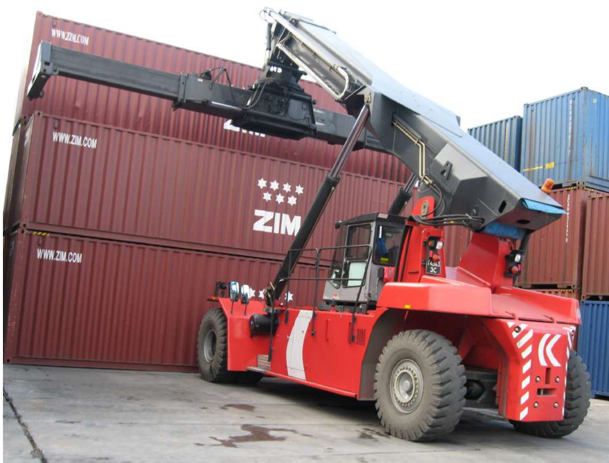
Рисунок 1.10 – Вантажні операції з контейнерами, що виконуються річстакерами
