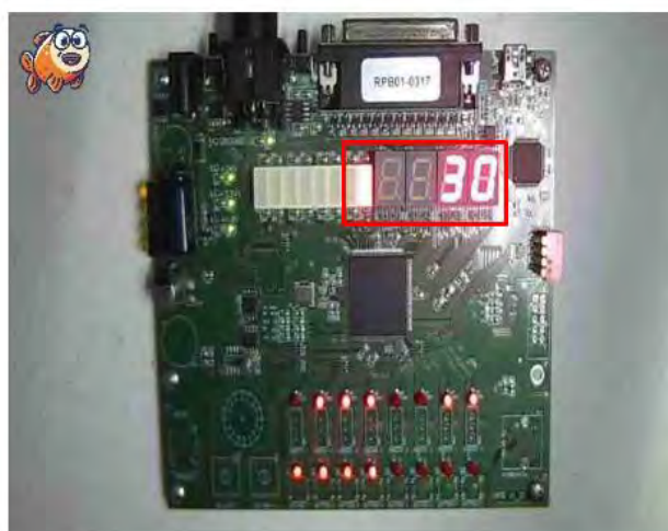
Рисунок 3.9 – Тестування 2-розрядного BCD-суматора у віддаленій лабораторії GOLDi
