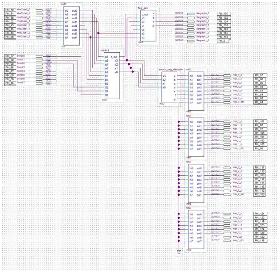
Рисунок 2.85 – Тестування 4-бітного АЛП
