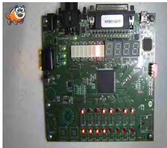
Рисунок 3.11 – Тестування 8-бітного комаратору у віддаленій лабораторії GOLDi
