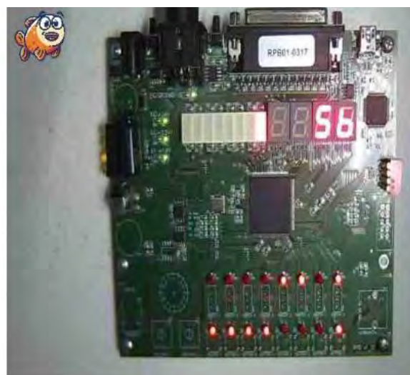
Рисунок 3.10 – Тестування 8-бітного суматору/віднімача у віддаленій лабораторії GOLDi
