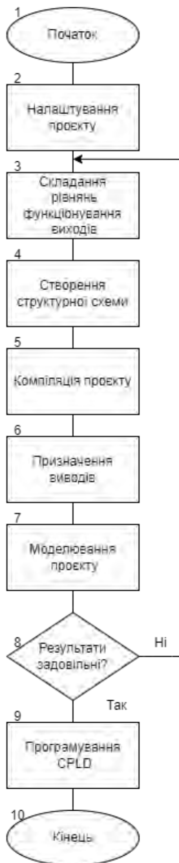
Рисунок 2.3 – Схема алгоритму розробки бібліотечних елементів
