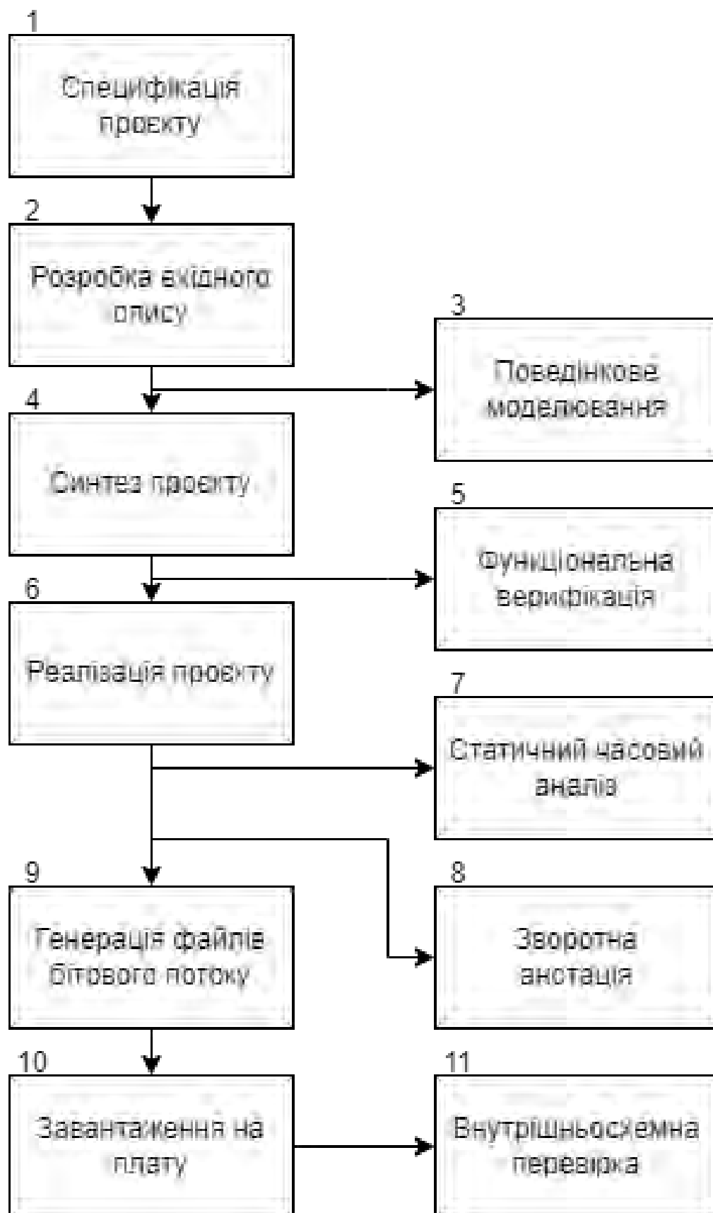
Рисунок 1.3 – Узагальнений алгоритм проєктування ЦП [13]
