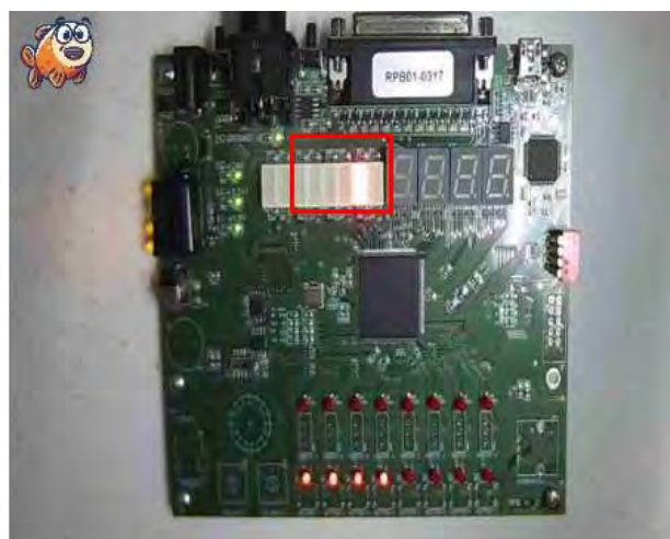
Рисунок 3.12 – Тестування 4-бітного ітеративного комаратору у віддаленій лабораторії GOLDi
