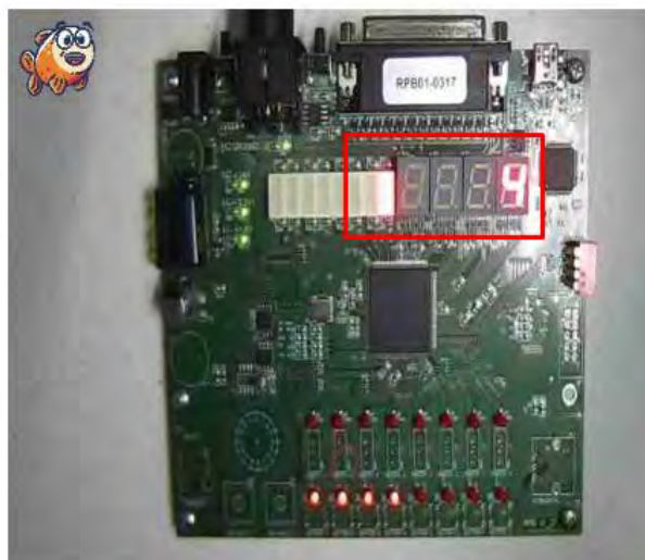
Рисунок 3.8 – Тестування 4-бітного суматора у віддаленій лабораторії GOLDi
