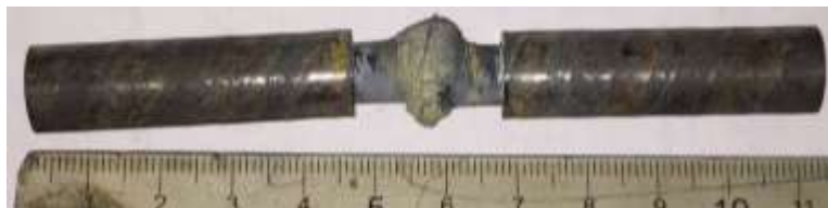
Рисунок 4.2 – Вигляд зварного з'єднання заготовки із спеченого титану ВТ1-0, отриманого контактним стиковим зварюванням оплавленням
