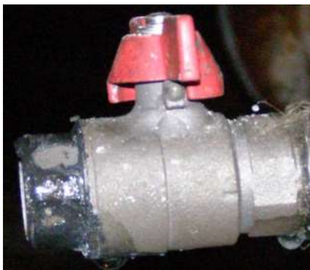
Рисунок 5.2 – Зовнішній вид кульового крану після випробування на ТОВ «Запорізький титано-магнієвий комбінат»
