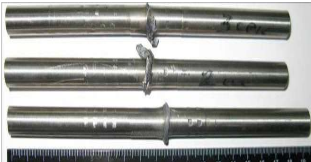
Рисунок 4.7 – Зовнішній вид зварного з'єднання зразків із спеченого титану BT1-0, виконаного конвекційним зварюванням тертям
