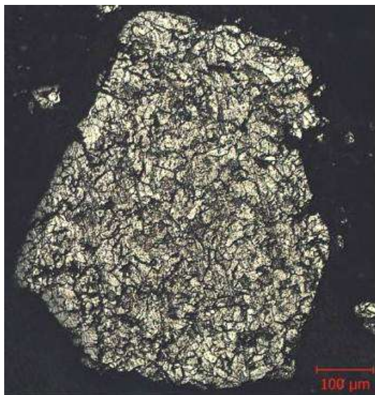
Рисунок 3.1 – Макроструктура частинки порошку титану марки ПТ
