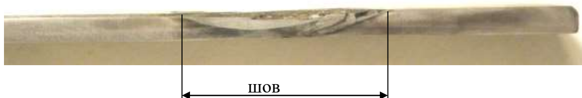
Рисунок 4.14 – Вид зварного з'єднання зразків із спеченого титану BT1-0, виконаного зварюванням тертям перемішуванням
