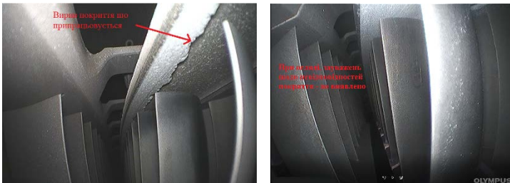
Рисунок 2 – Вирив покриття, що припрацьовується
