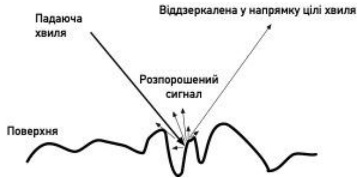
Рисунок 2.3 – Розсіювання падаючої хвилі на поверхневих нерівностях
