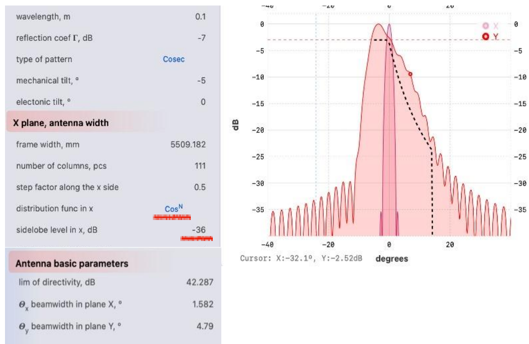
Рисунок 3.12 – Амплітудна діаграма спрямованості передавальної ФАР з послабленим бічним випромінюванням ліворуч від напрямку головного максимуму ДС
