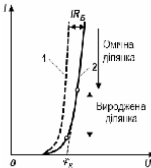
Рисунок 3.4 - Пряма гілка ідеального p - n переходу та ВАХ діода
