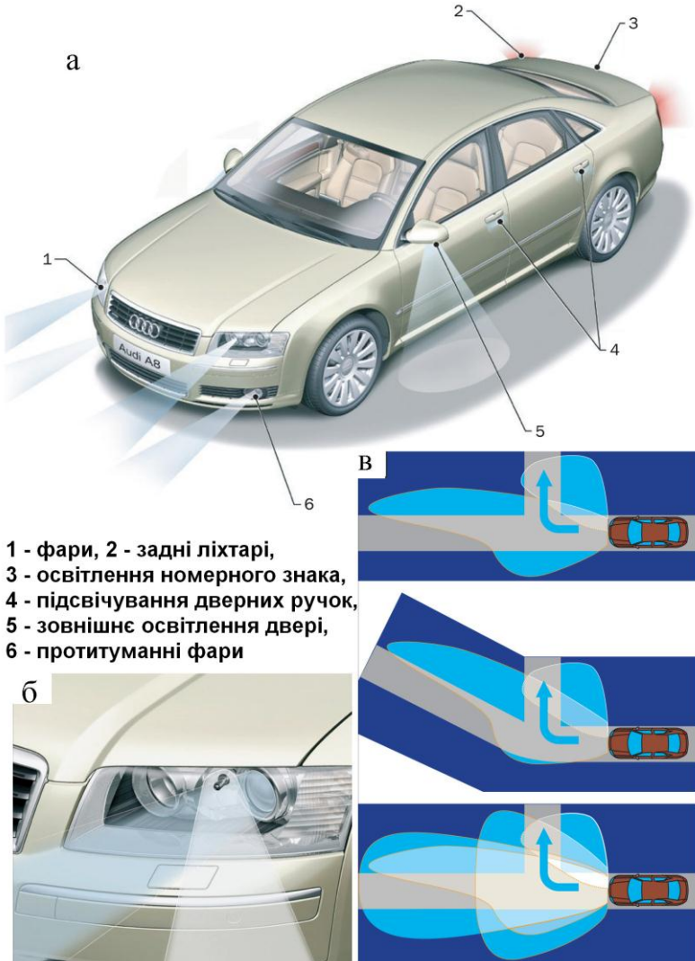
а - розташування та типи зовнішніх світлових приладів автомобіля, б - регульовані фари (такі що повертаються), в- сучасні системи головного освітлення автомобіля з регульованими світловими потоками
