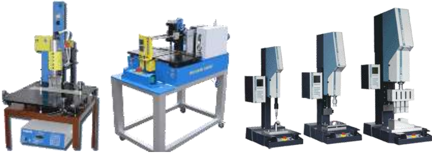
Рисунок 2.4 – Обладнання для зварювання неметалевих матеріалів. Спеціальні установки УЗЗ плівок (12-30 мкм) з ПЕТФ по контуру (а) та шовно (б). Ультразвукові зварювальні преси: легкого (USP-400), середнього (USP-750) та важкого типу (USP-3000) (в)
