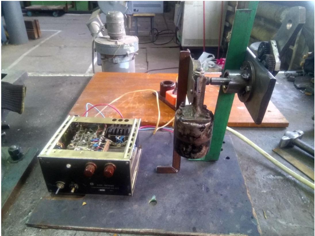
Рисунок 1.11.- Експериментальна модель планетарного механізму зі збільшеним ходом повзуна із зовнішнім зачепленням
