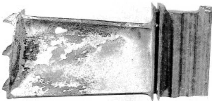
Рисунок 1 – Робоча лопатка газотурбінного нагнітача ГТН-16 після тривалої експлуатації (більш 17 тис. год).
