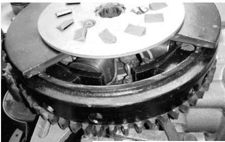
Рисунок 1 – Розрізи маховика двигуна «Вихрь-25» (а) і кришки клапанного механізму двигуна Volkswagen YN (б).
