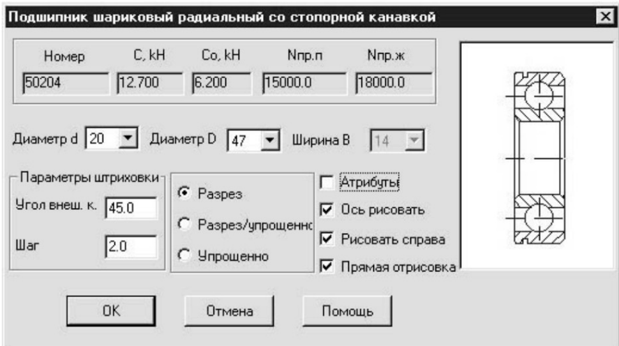
Рисунок 6.2 - Використання шаблону для вибору параметрів підшипника
