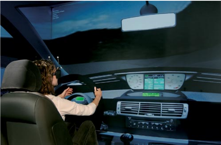
Рисунок 10.5 - "Віртуальна перевірка" зовнішньої оглядовості з місця водія
