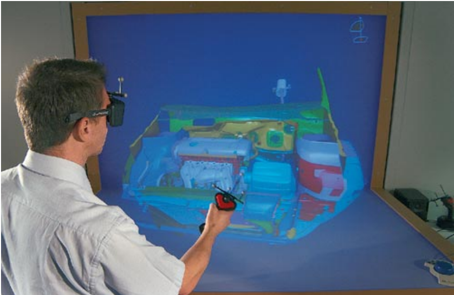
Рисунок 10.4 - "Віртуальне компонування" моторного відсіку автомобіля "Пежо-206"
