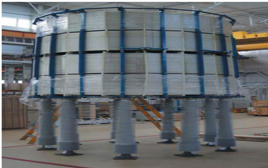
Рисунок 1 – Шунтирующий реактор. Класс напряжения 110кВ.
