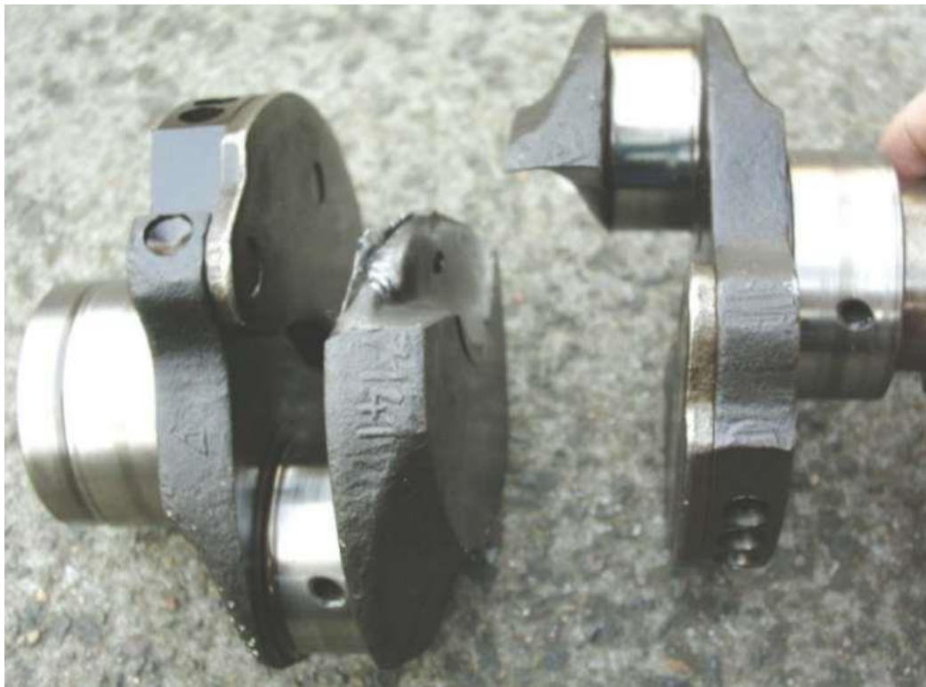
Рисунок 1.4 – Колінчастий вал зі зламом по центральній щоці
