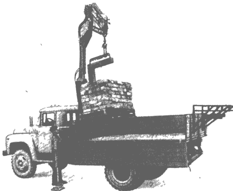
Рисунок 2.2 - Бортовий маніпулятор у робочому положенні
