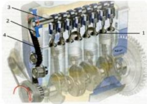
1 – клапани; 2 – привід клапанів; 3 – розподільний вал; 4 – привід розподільного валу Рисунок 2.3 – Загальний пристрій газорозподільного механізму
