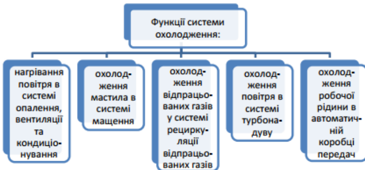
Рисунок 2.8 – Функції системи охолодження
