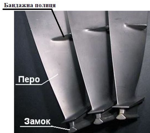
Рисунок 1.2 –Робоча лопатка компресора [2]
