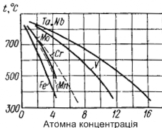
Рисунок 1.12 – Залежність температури мартенситного перетворення титанових сплавів від вмісту \beta -стабілізаторів [16]
