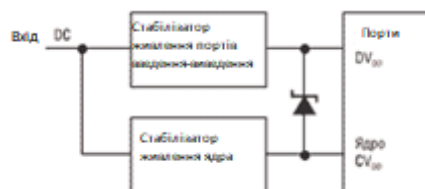
Рисунок 3.4 – Використання діода Шотки для обмеження різниці живлячої напруги
