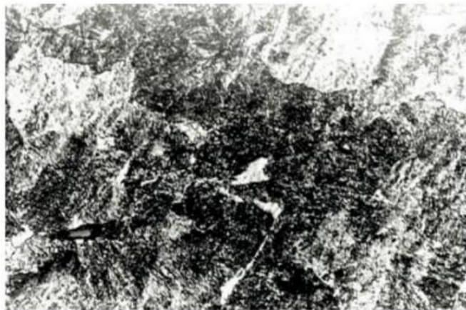
Рисунок 1.3 – Мікроструктура зуба шестерні зі сталі 40Н (×500) [2]
