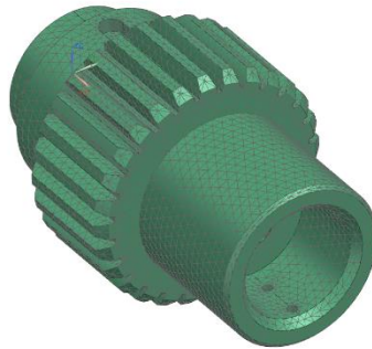
Рисунок 5.1 – 3Д-модель деталі розбита на сітку кінцевих елементів
