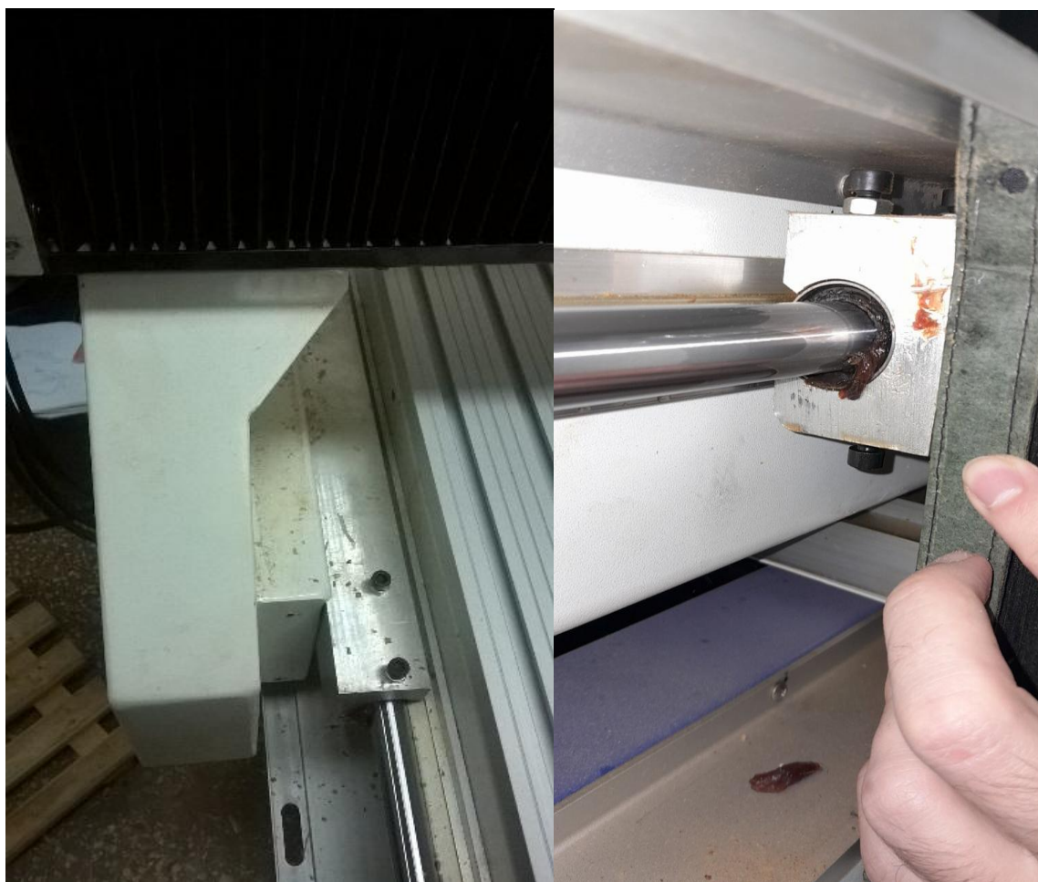
Рисунок 3.3 — Вимірювання напрямних столу.
