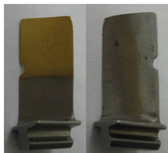
Рис. 5.19. Зовнішній вигляд лопатки компресора до і після зняття захисного покриття TiN ( \times 2 )
