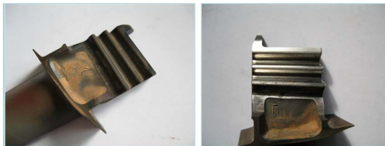
Рис. 5.18. Хвостовик лопатки турбіни до і після видалення нагару ( \times 0,5 )
