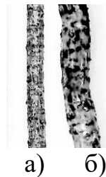
Рис. 1.3. Волокна полімерно-абразивних щіток ( \times 10 ): а – ПА волокно (0,6 мм); б – гофроване ПА волокно (1,2 мм)
