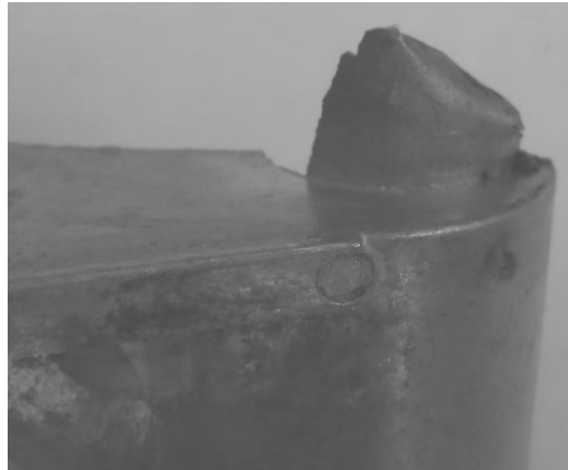
Рис. 5.16. Облой, що залишився на виливках (×3)
