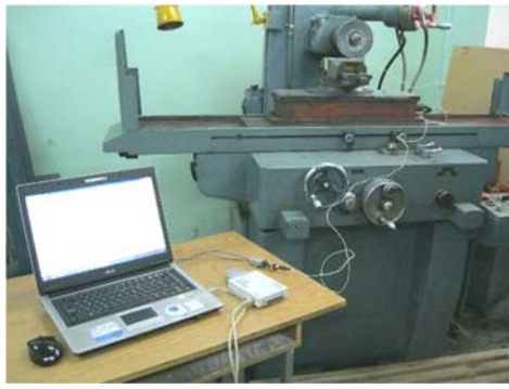
Рис. 4.9. Загальний вигляд установки для проведення температурних досліджень при обробці ПАЩ
