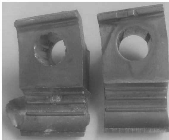
Рис. 5.17. Крайки корпусу до і після обробки ПАЩ
