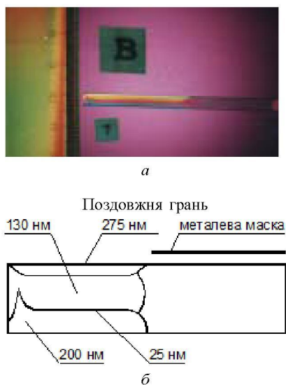
Рис. 4. Загальний вигляд пластини зі скла К8 прямокутної форми з картиною подвійного променезаломлення (а) та відповідна їй схема з зображенням зон і величин напружень (б). Прилад ПКС-250
