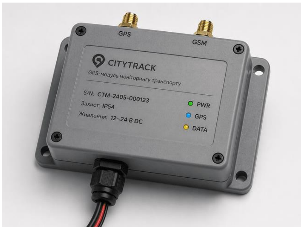
Рисунок 3.3 - Апаратний GPS-модуль у захищеному корпусі IP54
