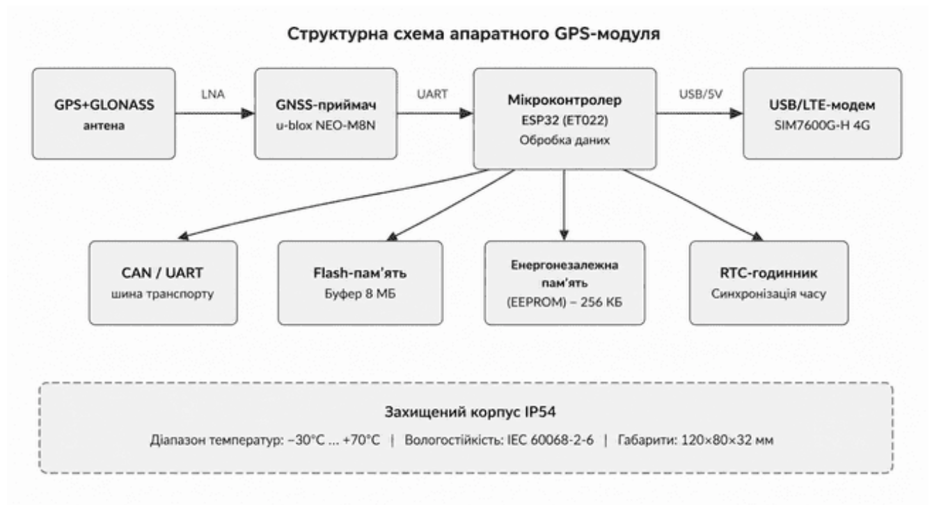
Рисунок 3.2 - Структурна схема апаратного GPS-модуля
