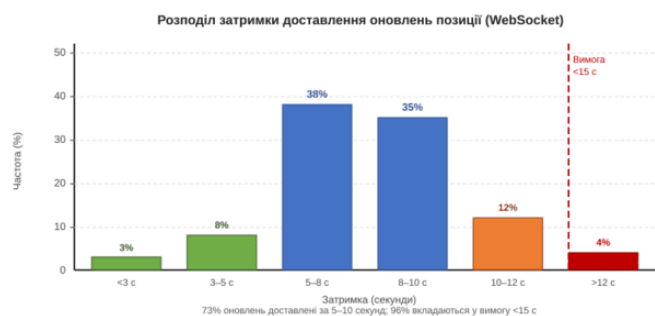
Рисунок 4.4 - Розподіл затримки доставлення оновлень позиції транспорту (WebSocket)
