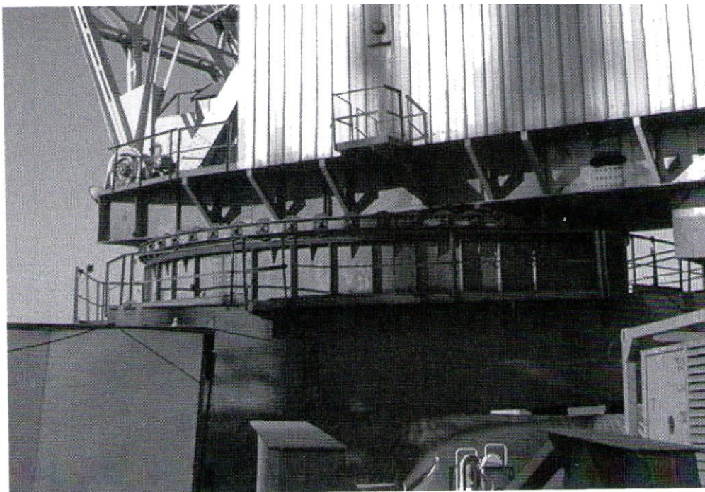
Рисунок 3.8 – Опорно-поворотний пристрій (ОПП) на прикладі стапельного крана
