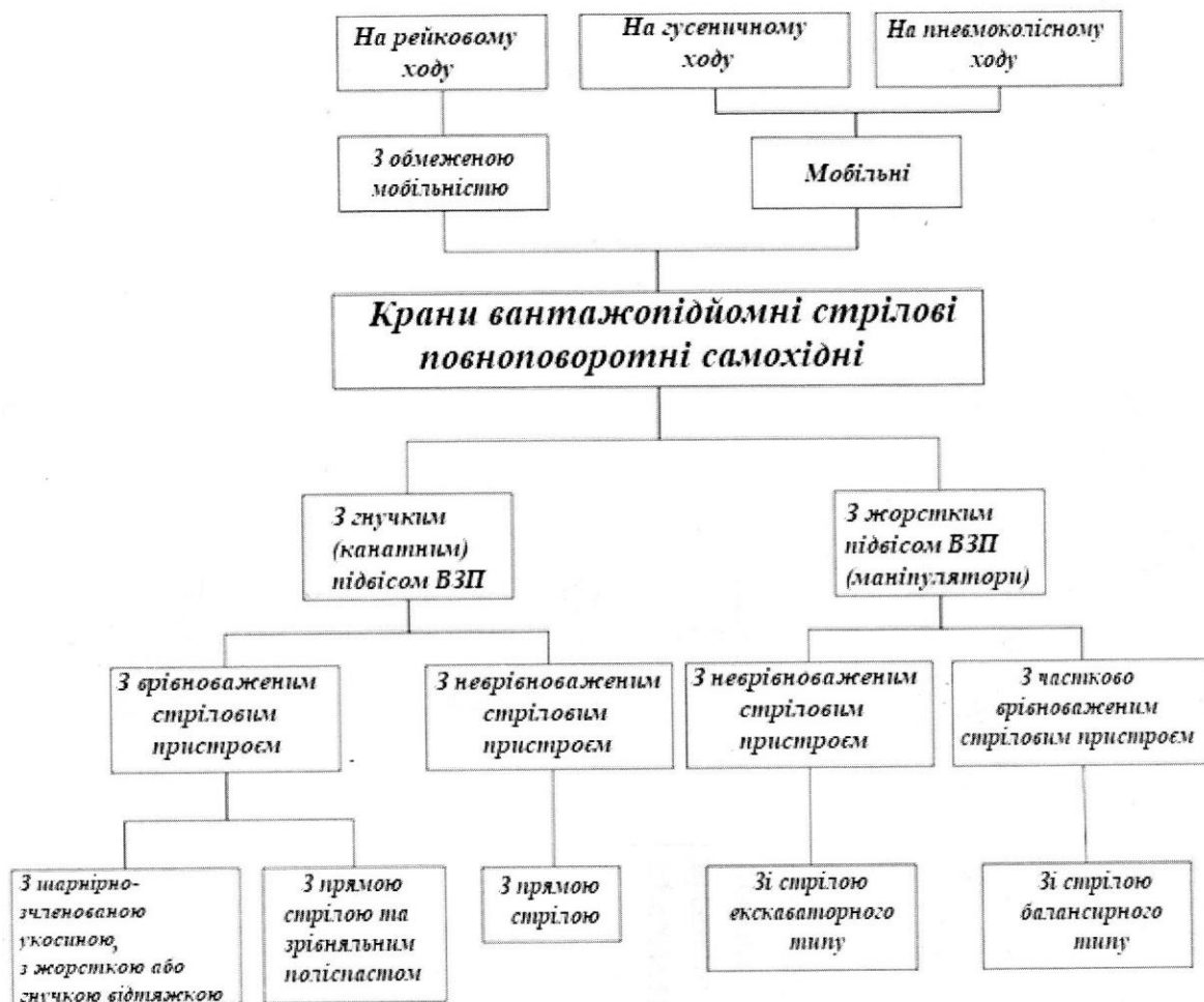
Рисунок 4.7 - Класифікація основних типів повноповоротних стрілових самохідних кранів
