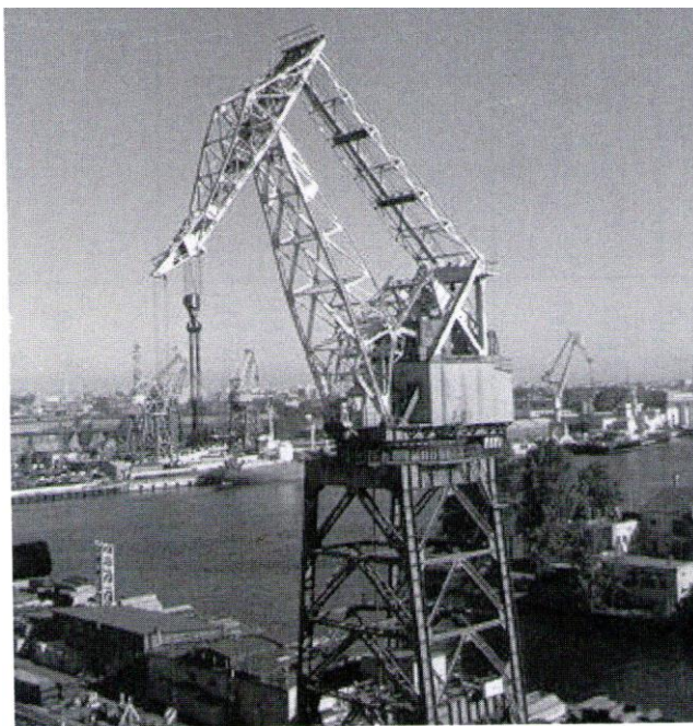
Рисунок 3.11 – Приклад шарнірно-зчленованої стріли з жорсткою відтяжкою
