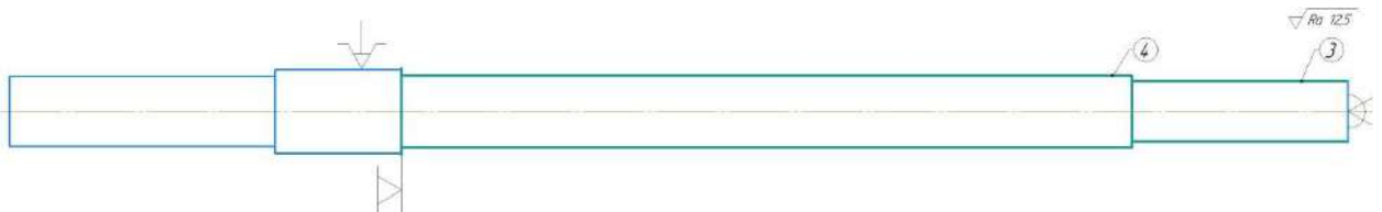
Рисунок 1.4 – Чорнова база при першій токарній обробці операції 020
