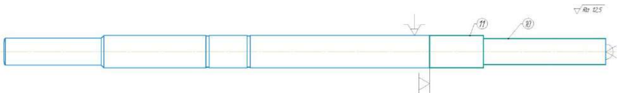
Рисунок 1.5 – Чистова база під час токарної операції 030
