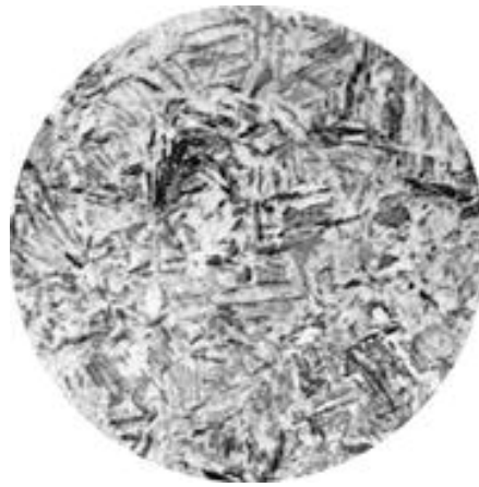
Рисунок 3.7 – Структура сталі 40Х після гартування
